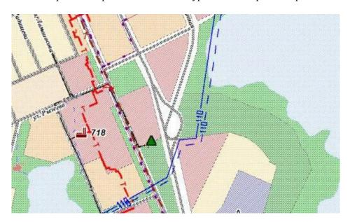
Проектом планировки предполагается установка опоры №52а в месте планируемой дорожной развязки. Также данная опора размещена в санитарной зоне АЗС, размер зоны устанавливается исходя из требований взрыво-пожарной безопасности. В случае возникновения аварии на территории АЗС опора №52а окажется в радиусе поражения взрывной волны.
